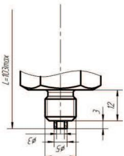
Датчики МИДА-ДД-15(-Ex) с выходным сигналом в виде постоянного тока или напряжения по постоянному току и наличием подстройки «нуля» и «диапазона» (код сигнала 01, 051, 052)
