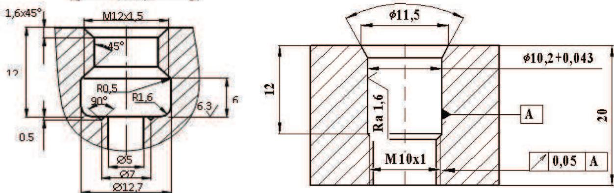
**Монтажные гнезда и установка датчиков МИДА-ДИ-12П-072**
