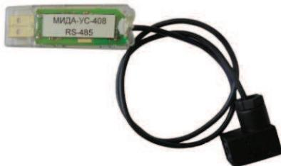
Устройство связи МИДА-УС-408 предназначено для сопряжения датчика МИДА-15 с цифровым выходом и типом интерфейса UART или RS485 с персональным компьютером, для предварительной настройки и проверки его работоспособности (без гальванической развязки).
