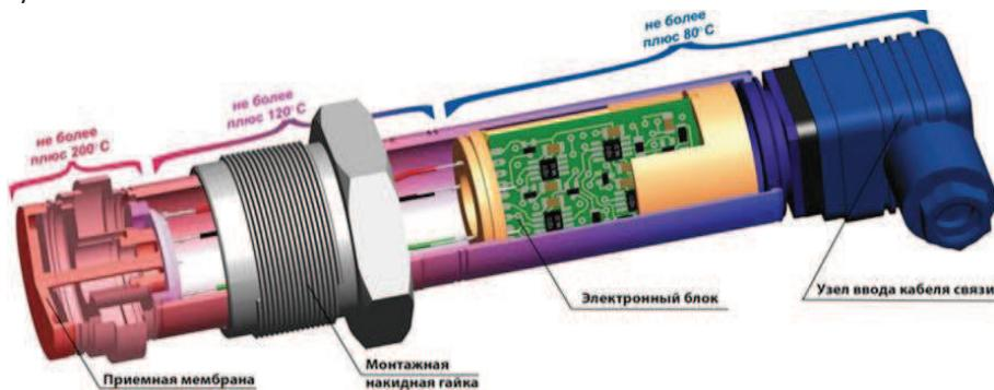
Тензопреобразователь датчика включает открытую приемную мембрану соединённую штоком с измерительной мембраной, на которой жёстко закреплён полупроводниковый чувствительный элемент, представляющий собой монокристаллическую сапфировую подложку, на поверхности которой сформированы гетероэпитаксиальные кремниевые резисторы (структуре кремний на сапфире – КНС), алюминиевые проводники разваренные на чувствительный элемент и на выводы коллектора.
