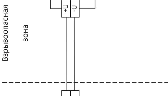
**Барьер МИДА-БИЗ-107-Ex-05 с взрывозащищенным исполнительным устройством**
