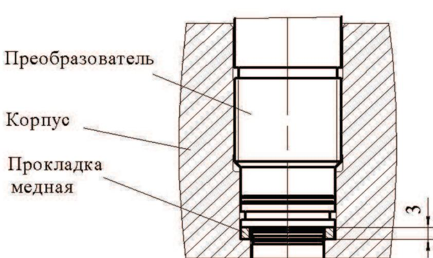
**Монтажное гнездо и установка датчиков МИДА-13П с открытой мембраной**
