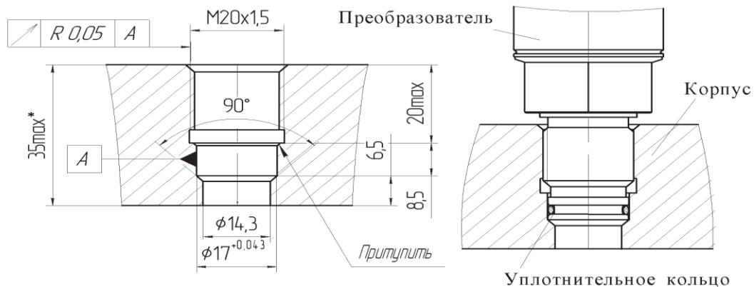
**Монтажные гнезда и установка датчиков МИДА-ДИ-12П-05, МИДА-ДИ-12П-06 и модулей МИДА-МИ-41**
