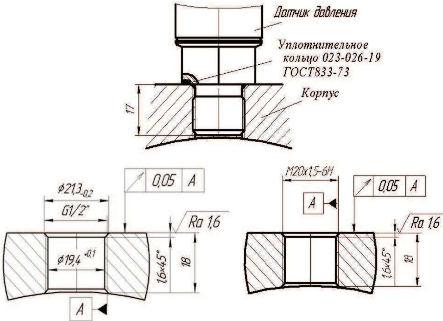
**Монтажное гнездо и установка модулей МИДА-МИ-45**
