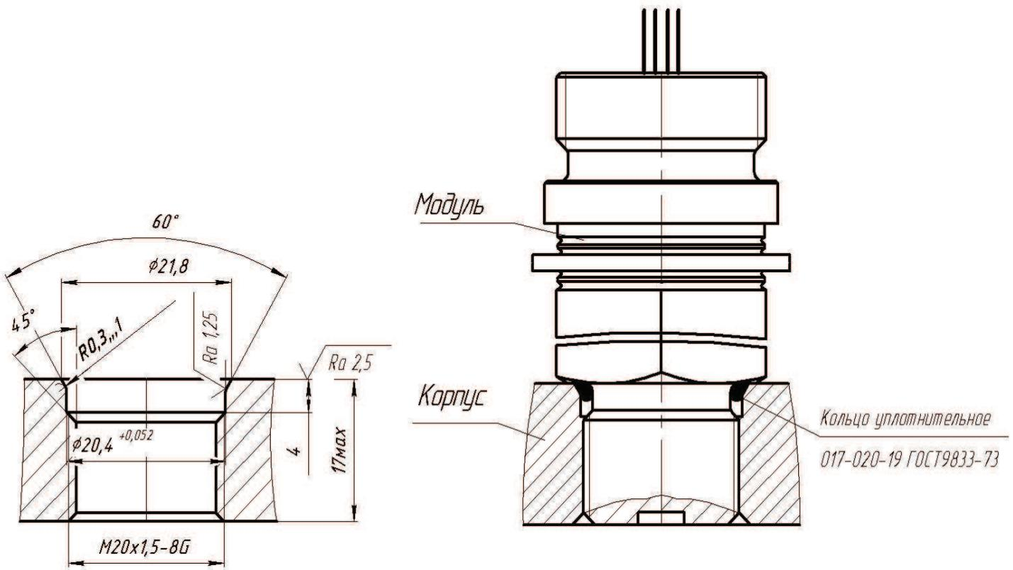
**Монтажные гнезда и установка датчиков МИДА-ДИ-12П-082**
