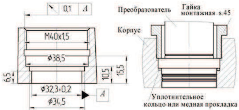
**Монтажные гнезда и установка датчиков МИДА-ДИ-12П-081**
