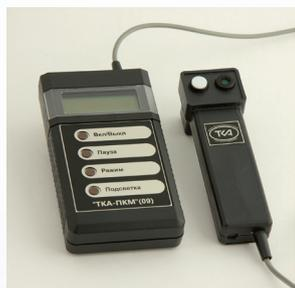
Прибор предназначен для измерения коэффициента пульсации освещённости и освещённости в видимой области спектра (380-760) нм и яркости накладным методом ТВ-кинескопов, дисплейных экранов и протяжённых самосветящихся объектов в видимой области спектра (380-760) нм.
