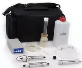
Автономная воздуходувка с таймером, оснащенная различными пробоотборными устройствами, которые позволяют проводить отбор проб радона в различных средах (вода, воздух, почвенный воздух, поверхность грунта) и измерять объемную активность радона в воде, почвенном воздухе, плотность потока радона с поверхности грунта.
