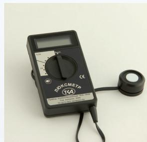
Прибор предназначен для поверки (калибровки) рабочих средств измерения освещённости, создаваемой стандартными источниками оптического излучения с различной цветовой температурой, расположенными по нормали к чувствительной площадке приёмника излучения, методом прямых измерений. Лучший по своим характеристикам отечественный люксметр, не уступающий зарубежным аналогам, надежен и прост в эксплуатации.
