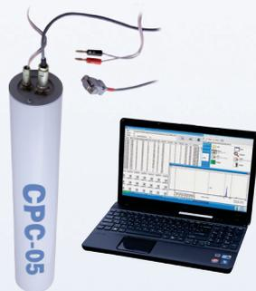
Автономная станция для геофизических исследований. Может применяться для автоматизированных непрерывных измерений ОА радона-222 и торона-220 в почве с сохранением всех результатов измерения и выводом данных на IBM PC. Контролирует температуру, относительная влажность и давление.
